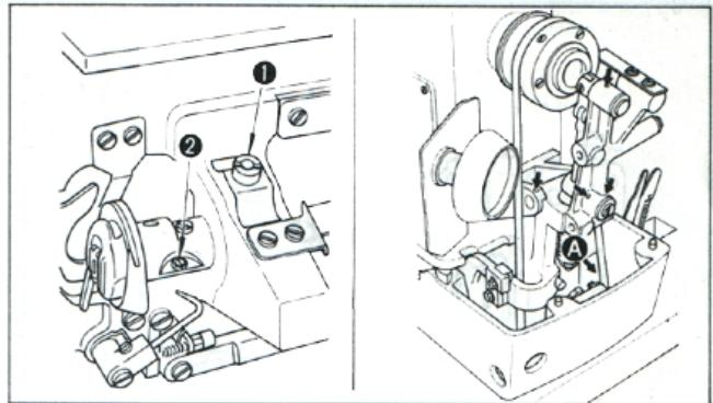
\*Регулировка смазки челнока
