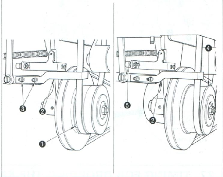
\*Регулировка положения передвижного устройства ремня
