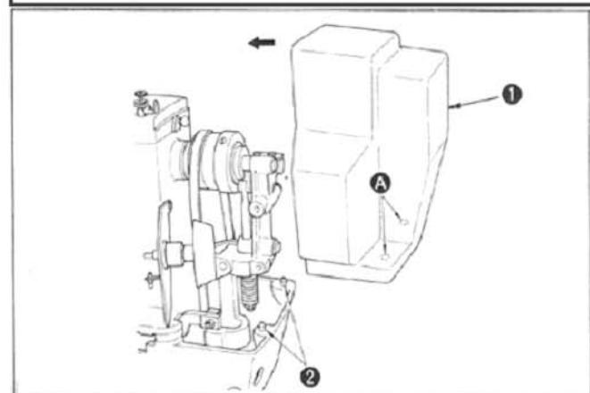
Выровняйте шпильку направляющей (2) и отверстие (A) в кожухе ремня (2), затем толкните кожух ремня по направлению указанному стрелочкой, до щелчка. Чтобы снять кожух ремня, прижмите кожух ремня в направлении, указанном стрелочкой, затем вытяните его.
