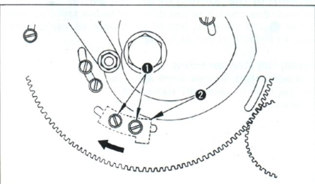
Ослабьте винты (1), передвигните режущий сегмент ножа (2) в направлении, показанном на стрелке, и нож будет опускаться раньше. Отрегулируйте так, чтобы нож опускался за два-три стежка перед остановкой машины.
