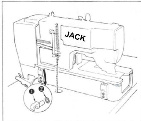
Установите подкладку (2) в шарнир (1), вставьте шарнир (1) в машинную головку. После этого установите машинную головку на основание машины.
