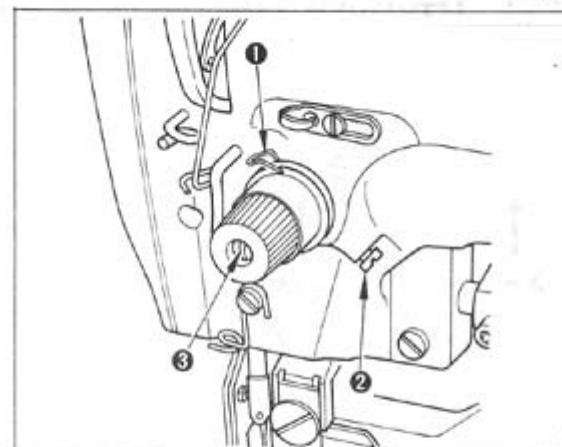
\* Регулировка пружины нитепрятгивателя (для бисерного стежка)
