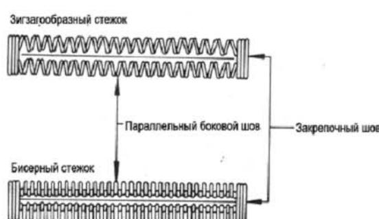
Данная машина может выполнять два разных вида стежка: зигзагообразный стежок и бисерный стежок.
