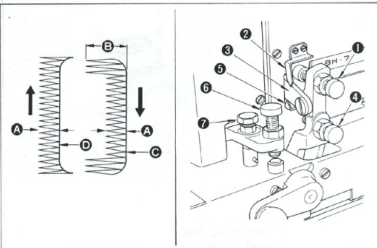
Игла движется справа налево, причём правая линия основания служит исходным положением. Регулировку следует проводить следующим образом:
