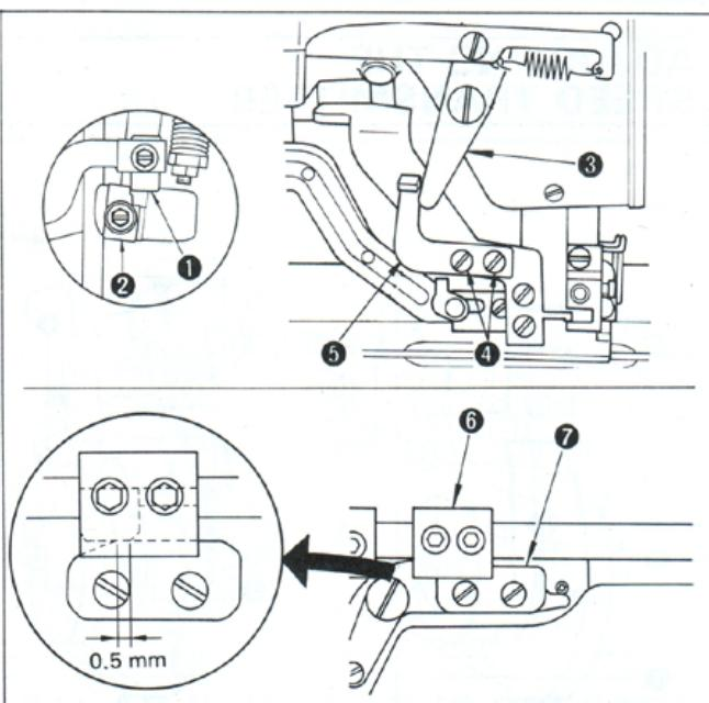
Ослабьте установочный винт (4), установите и отрегулируйте ограничительную пластину (5) так, чтобы она вступала в контакт с блокирующим плечом (3) во время медленного запуска машины (когда защелка В (1) сцеплена с защелкой А (2)).
