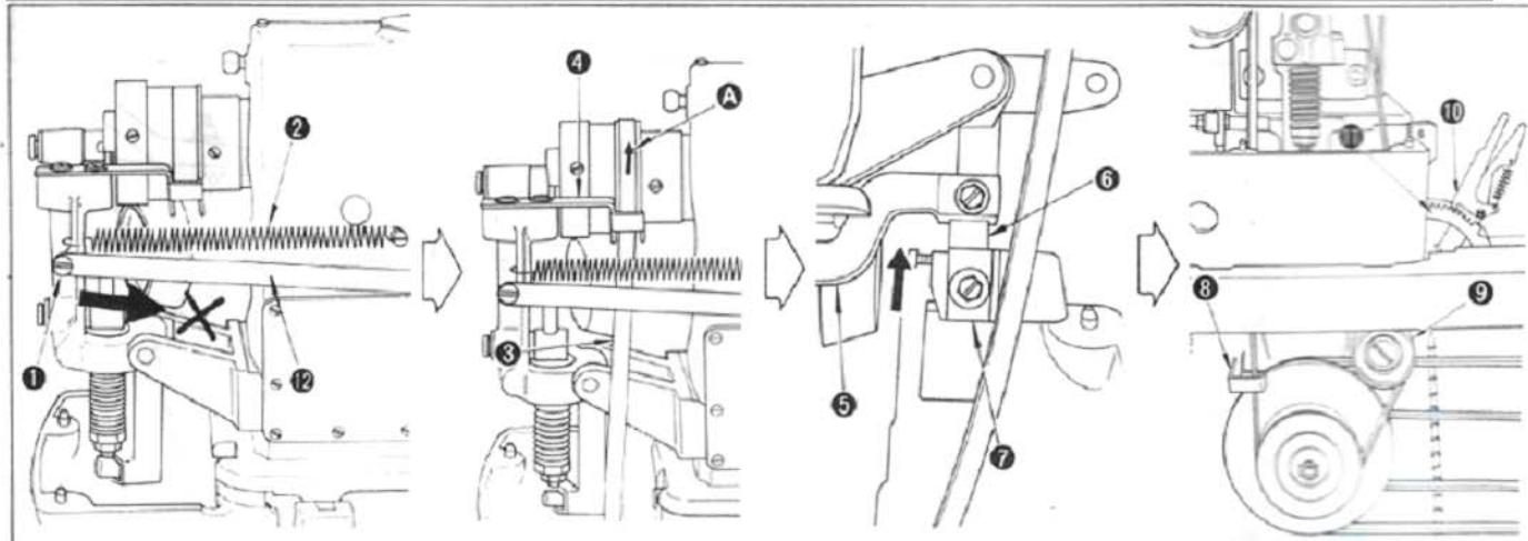
1 Удалите винт (1), затем удалите пружину (2) от винта подвески.
