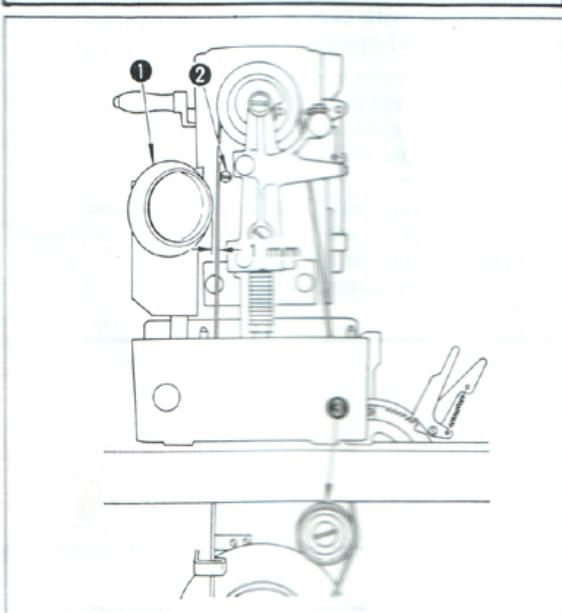
Ослабьте винт (2), и отрегулируйте таким образом, чтобы зазор между шкивом намотчика нити шпульки (1) и ремнём (2) был равен приблизительно 1 мм, когда шкив (1) находится отдельно от ремня.
