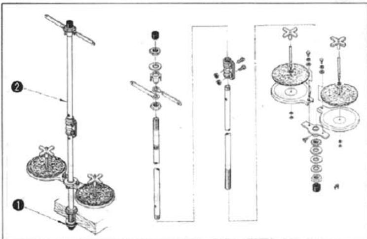
Соберите стойку для нитей, установите её на столе, в предусмотренном для этого отверстии. Затем затяните контргайку (1), чтобы зафиксировать стойку. Если проводка идёт наверх, по потолку, то силовой кабель следует прокладить через стержень основания (2).
