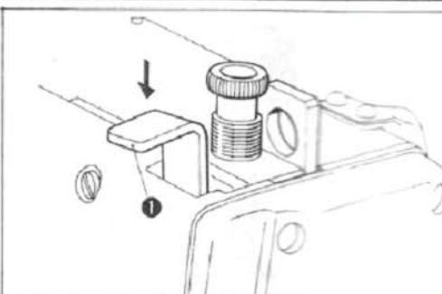
Если Вы не хотите отрезать ткань после пошива по той причине, что ранее произошел обрыв нити, или по какой-либо другой причине, слегка нажмите рычаг остановки ножа (1) до момента остановки машины.
